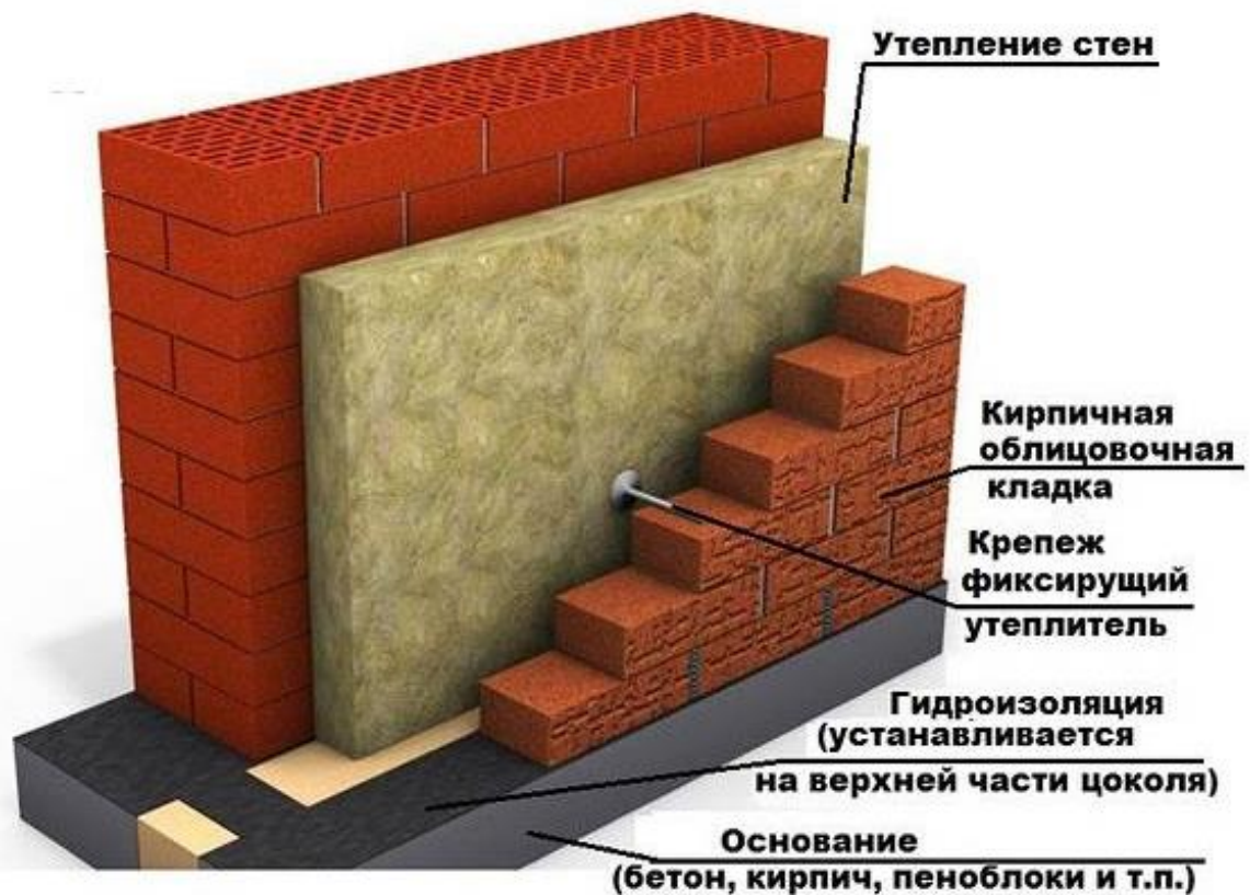
Рис.2.3 Рекомендована конструкція утеплення стін депо.
