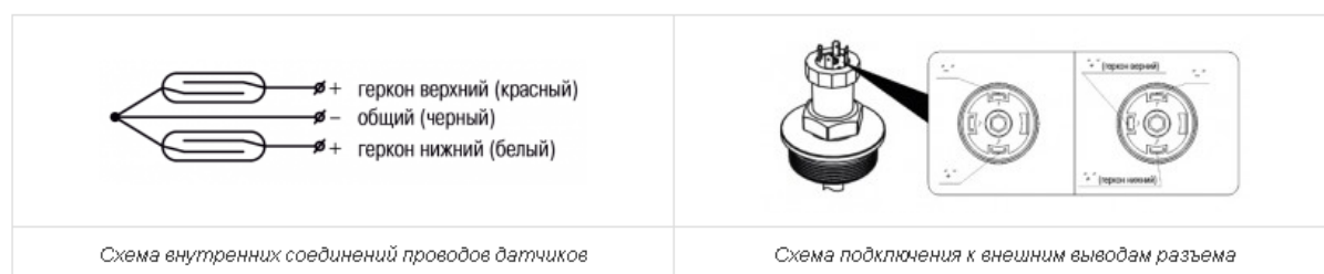
Рис. 5.5 – Схема підключення датчику рівня ПДУ – 2.2Н
