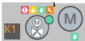
Рис. 7.4 – Екранні форми для контролю стану двигунів та виконавчих пристроїв.
