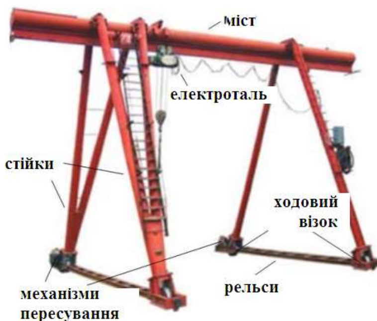
Рисунок 1.1 – Наглядний вигляд двостійкового козлового крана
