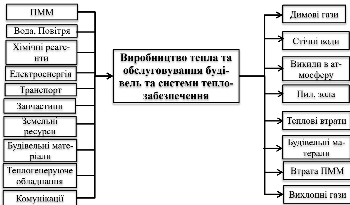
Рис. 3.4 – Вхідні і вихідні потоки речовини та енергії на стадіях виробництва тепла та обслуговування будівель та системи теплозабезпечення
