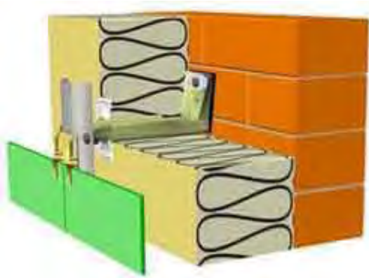
Рисунок 3.6 – Утеплені огорожувальні конструкції: А – каркасна стіна; Б - система зовнішнього утеплення зі штукатурним покриттям; В – конструкція навісного вентиляованого фасаду; Г - багатшарова конструкція плоского покриття з рулонною покрівлею.
