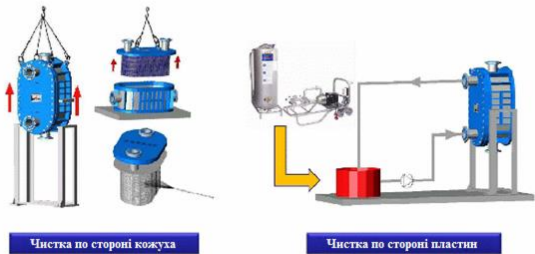
Рисунок 3.16. Варіанти чистки апарату з боку кожуха і пластин
