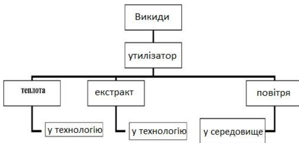
Рис. 4.1. Схема утилізації аерозольних викидів сушильної установки з використанням тепломасоутилізатора.
