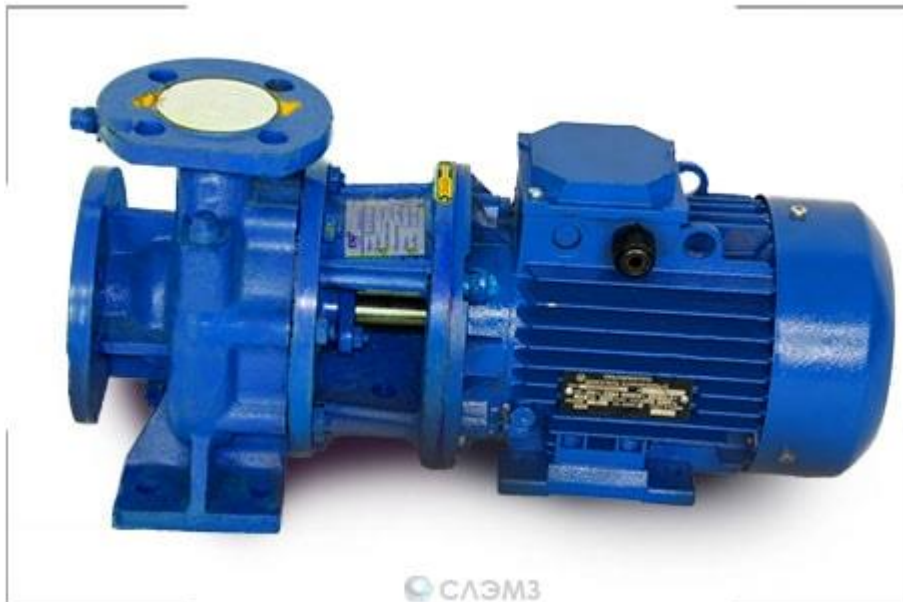
Рис.3.5 Зовнішній вигляд консольних насосів
