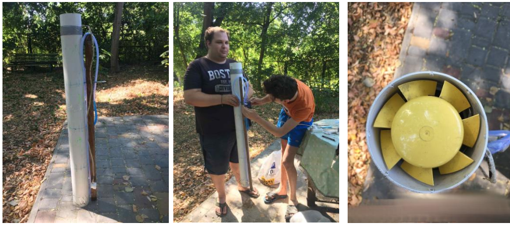
Рисунок 1. Експериментальне дослідження аеродинамічного опору щільного шару щєбня
