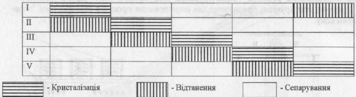
Рис. 8. Циклограма роботи п'ятизонного кріоконцентратора безперервної дії, I-V – концентратори
