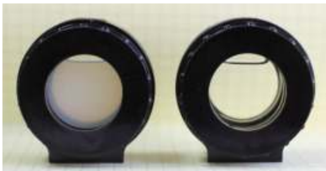
Рисунок 2.4 – Зображення зразків нанофлюїду R141b/наночастинок \text{TiO}_2 0,001 \text{ кг} \cdot \text{кг}^{-1} / ПАР Span-80 0,001 \text{ кг} \cdot \text{кг}^{-1} (ліворуч) і чистого R141 (праворуч) при 20 \text{ }^\circ\text{C} в герметичних оптичних комірках з довжиною оптичного шляху 4,05 мм
