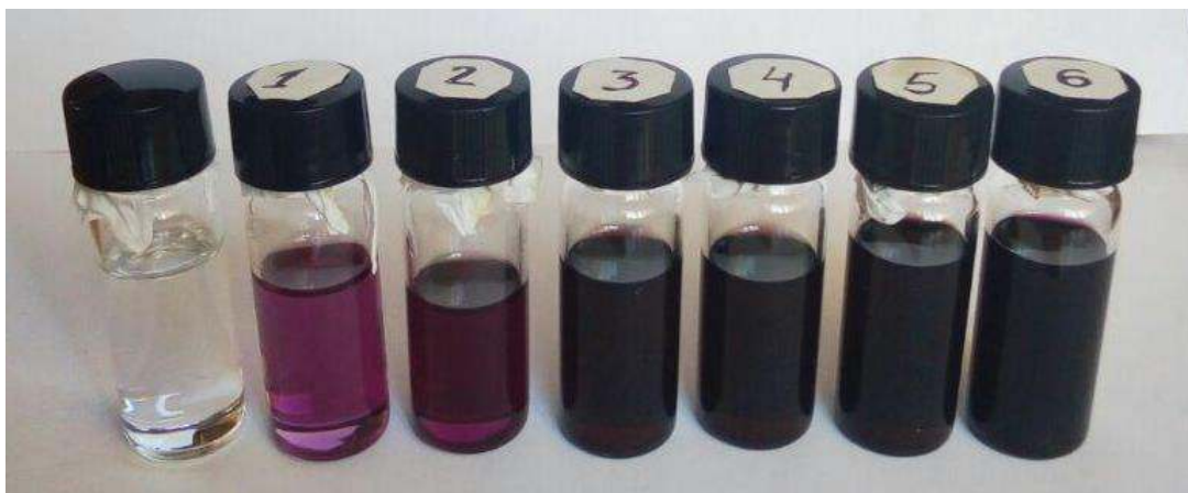
Рисунок 2.15 - Зображення зразків чистого тетраліну (базова рідина) та тетраліну з різним вмістом фулурунів C_{60} : 1 - 0,00058; 2 - 0,00177; 3 - 0,00565; 4 - 0,00687; 5 - 0,00836; 6 - 0,00972 \text{кг}\cdot\text{кг}^{-1}
