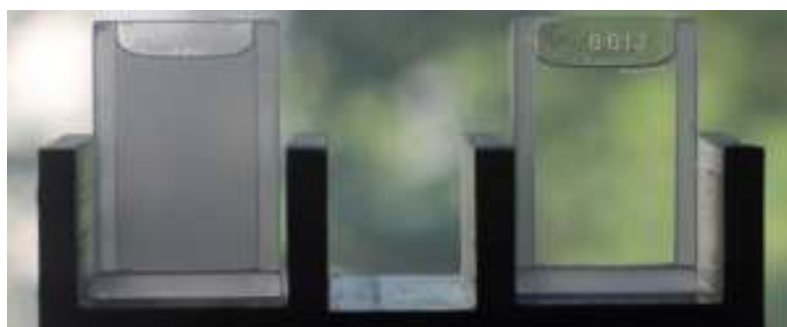
Рисунок 2.6 – Зображення зразків компресорного масла з наночастинками \text{Al}_2\text{O}_3 з концентрацією 0,0052 \text{ кг} \cdot \text{кг}^{-1} (ліворуч) і чистого компресорного масла (праворуч) в оптичних комірках з довжиною оптичного шляху 1,1 мм
