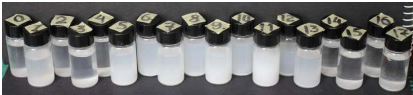
Рисунок 2.2 – Фотографії нанофлюїду R141b/наночастинок \text{TiO}_2 (Wenzhou Jingcheng Chemical Co) ( 0,00088/0,99912 \text{ кг} \cdot \text{кг}^{-1} ) (Номер на кришці відповідає номеру зразка в таблиці 2.1)
