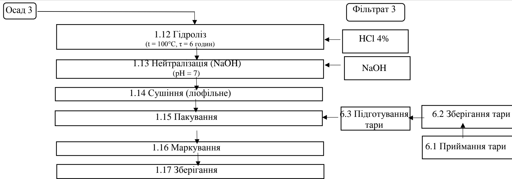
Рисунок 4.1- Технологія виробництва манолігосахаридного продукту пребіотичної дії
