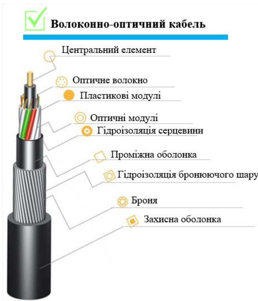
Рисунок.. 1.17. Структура оптоволоконного кабелю
