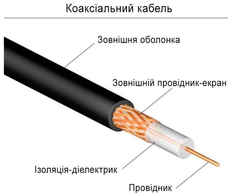
Рисунок. 1.15. Структура коаксіального кабелю
