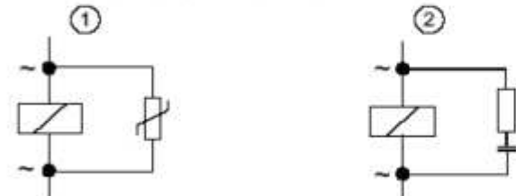
Рис. 3-3. Схемы защиты для катушек, обтекаемых переменным током
