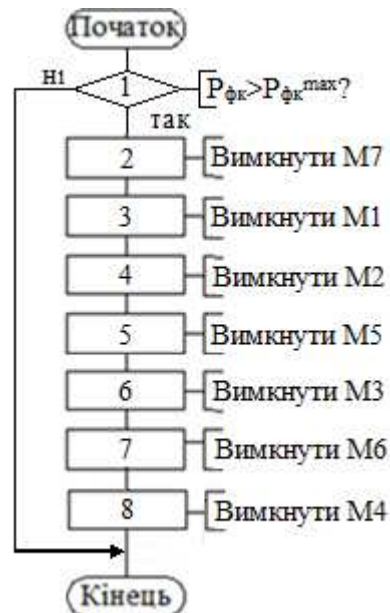
Рис. 4.7. Блок-схема алгоритму керування за аварійною зупинкою камери визрівання
