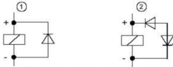
Рис. 3-2. Схемы защиты для катушек, обтекаемых постоянным током
