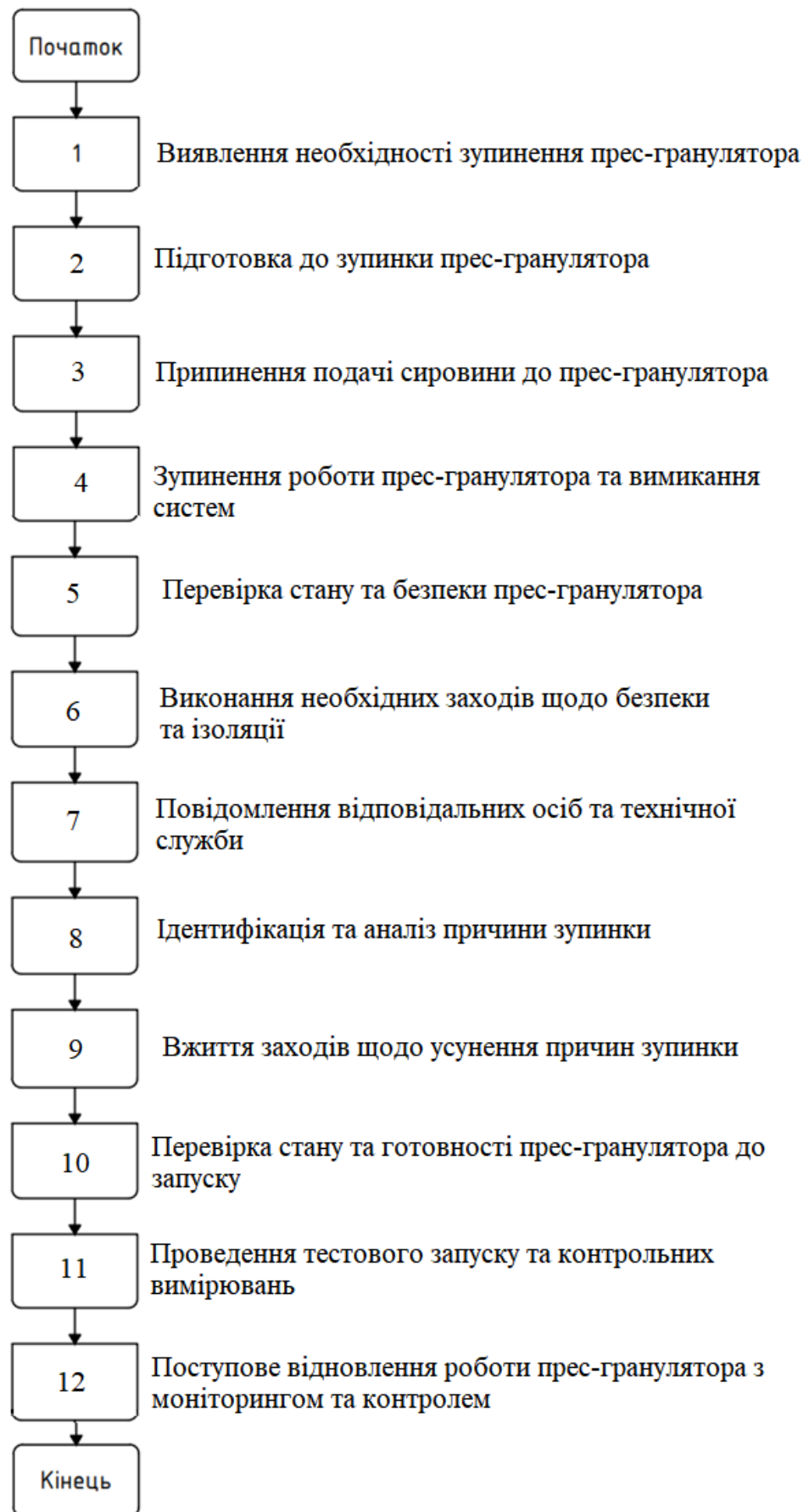
Рис. 6.5. Регламент функціонування прес-гранулятора за зупинкою
