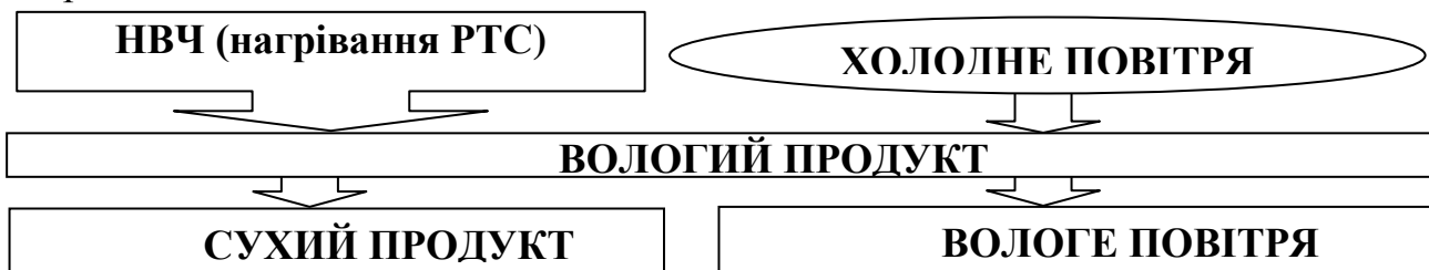
Рис. 1. Схема комбінованих процесів сушіння з використанням НВЧ та нагрівання РТС.
