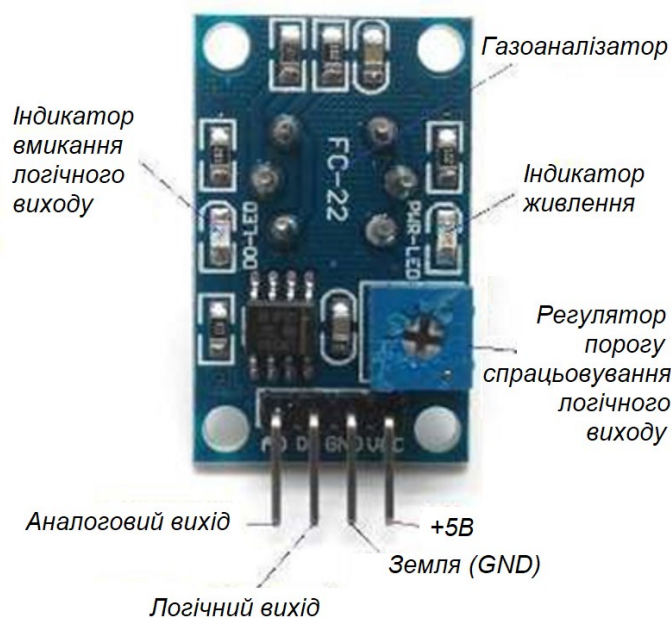
Рисунок 1.12. Основні компоненти газового сповіщувача MQ
