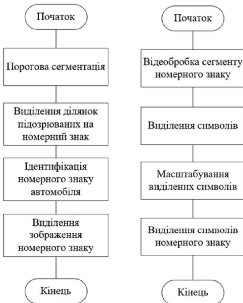
Рисунок 1.11. Основні етапи процесу виділення зображення номерного знаку автомашини
