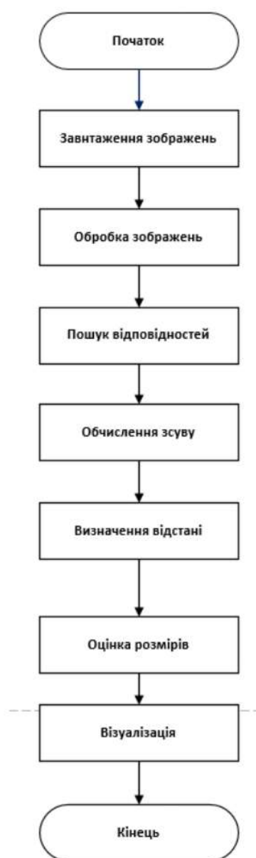
Рисунок 1.22. Блок-схема алгоритму стереоскопічної системи комп'ютерного зору.
