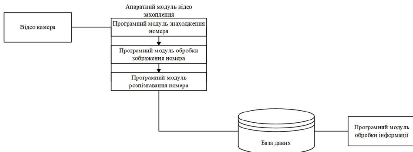
Рисунок 1.9. Узагальнена структурна схема системи розпізнавання номерних знаків автомашин з відеокамер.
