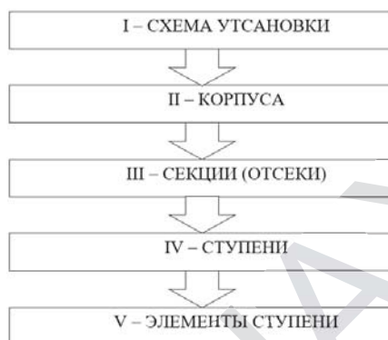
Рис. 1 Схема иерархии уровней технических систем
