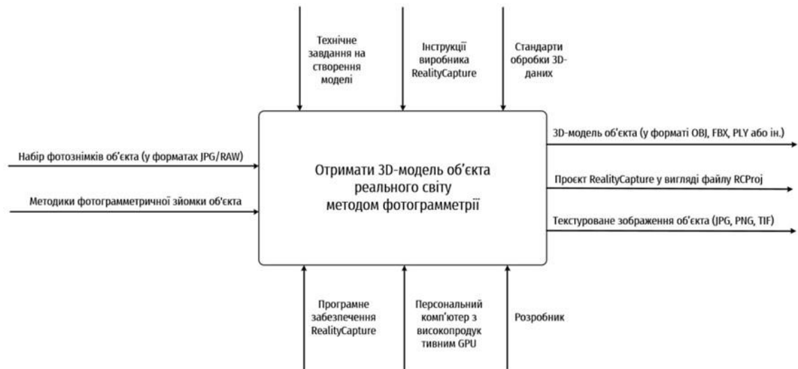
Модель IDEF0 тривимірної реконструкції об'єкта реального світу методом фотограмметрії
