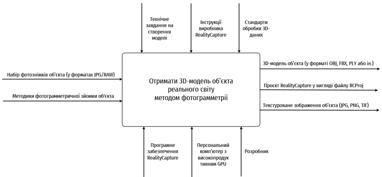
Рисунок 1.28. Модель IDEF0 тривимірної реконструкції об'єкта реального світу методом фотограмметрії
