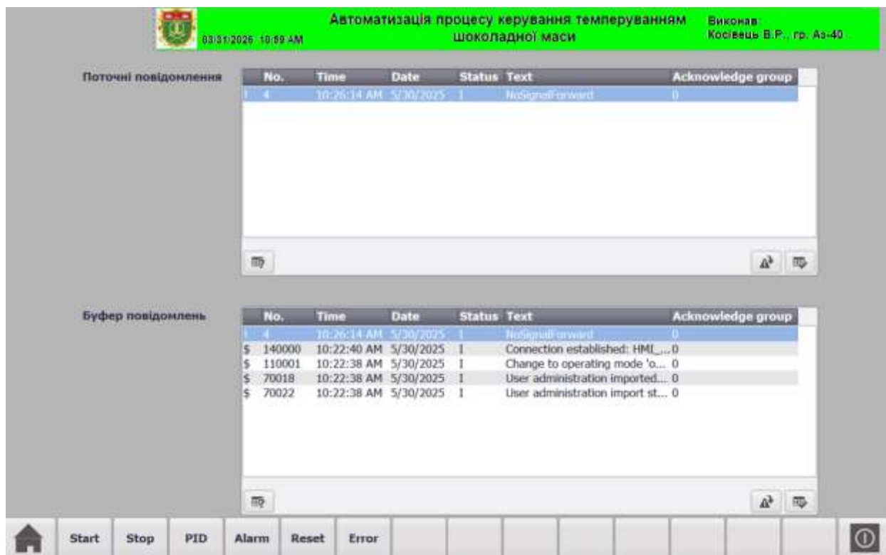
Рис. 7.19 – ЕкранAlarms в тестовому режимі при імітації несправності
