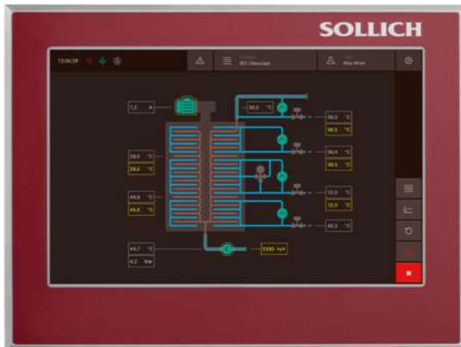
Рис. 1.6 – Зовнішній вигляд панелі оператора для модифікації машини Turbotemper ® е TE-D
