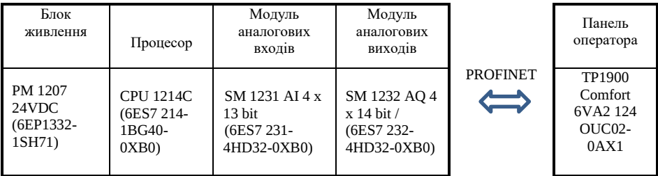
Рис. 5.11 – Схема технічної структури мікропроцесорного ядра системи керування
