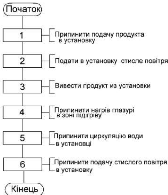
Рис. 4.3 – Блок-схема регламент на стоп технологічного циклу процесу темперування шоколадної глазури
