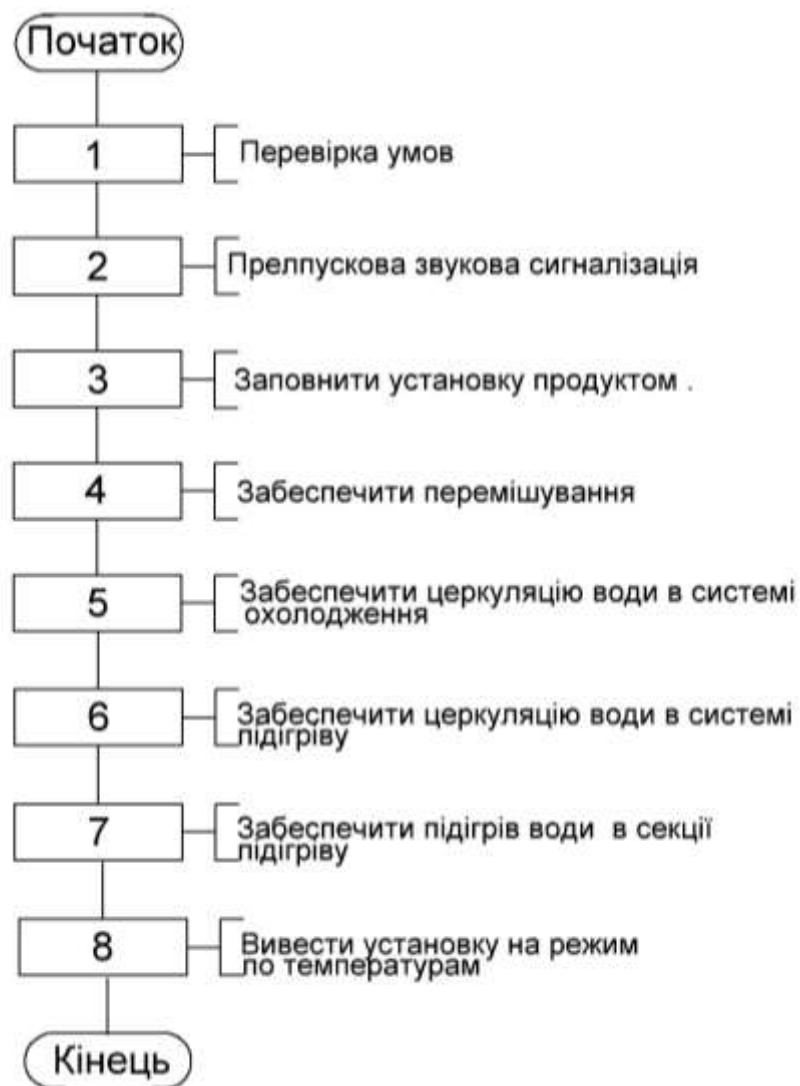
Рис. 4.2 – Блок-схема регламент на пуск технологічного циклу процесу темперування шоколадної глазури
