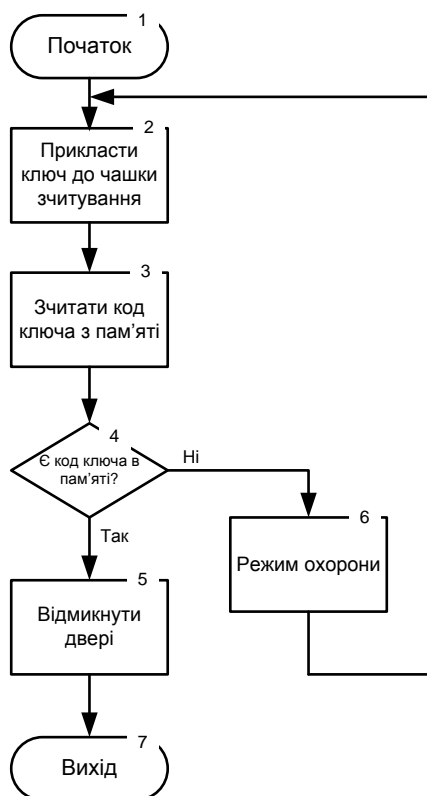
Рисунок 1.15 – Основний алгоритм роботи кодового замка
