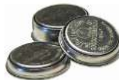
Рисунок 1.12 – Електронний ключ iButton (TOUCH MEMORY)
