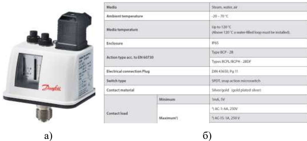
Рис. 5.3 – Датчик-реле тиску Danfoss BCP4H: а) зовнішній вигляд; б) технічні характеристики
