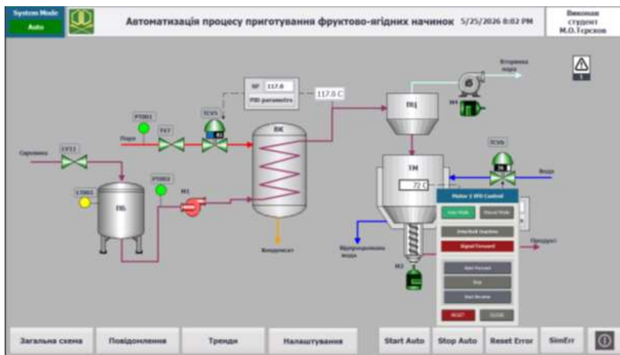
Рис. 7.19 – Головний екран в тестовому режимі при імітації несправності
