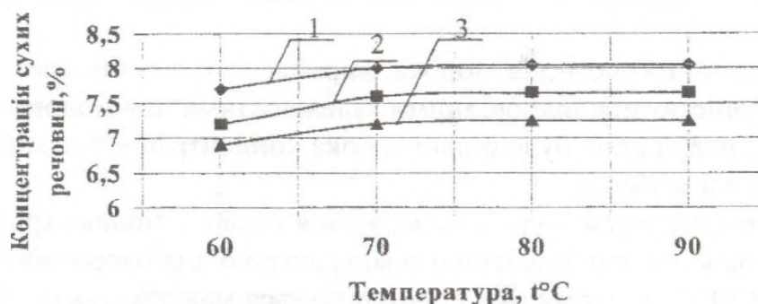
Рис.8. Залежність концентрації сухих речовин у соєвому молоці із сої лущеної від температури отримання і гідромодуля: 1 - 1:5; 2 - 1:8; 3 - 1:10.
