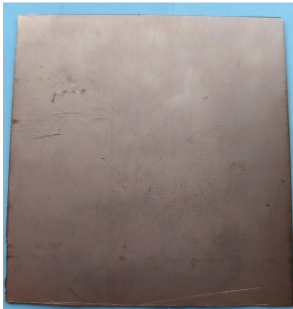
Рисунок 1.4 Односторонній текстоліт, покритий шаром міді
