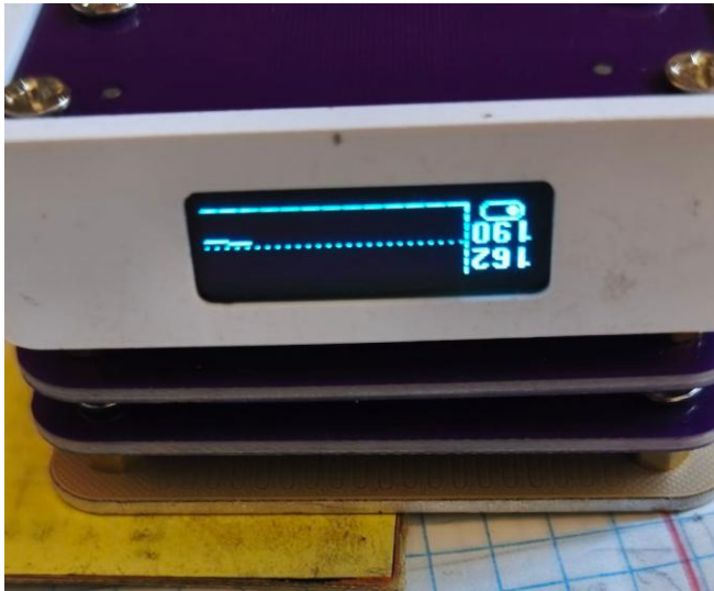
Рисунок 1.6 Прогрівання текстоліту з термопереносним папіром
