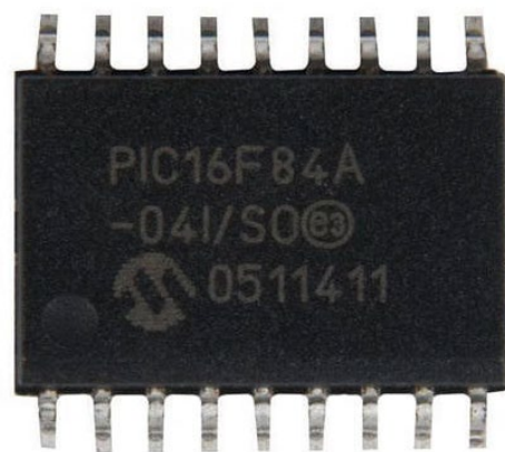
Рисунок 1.14. Контакти та зовнішній вигляд мікроконтролера PIC16F84A
