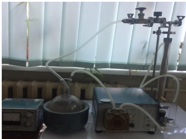
Рис. 2.1. Лабораторна мембранна установка для ультрафільтрації УПЛ-0,6
