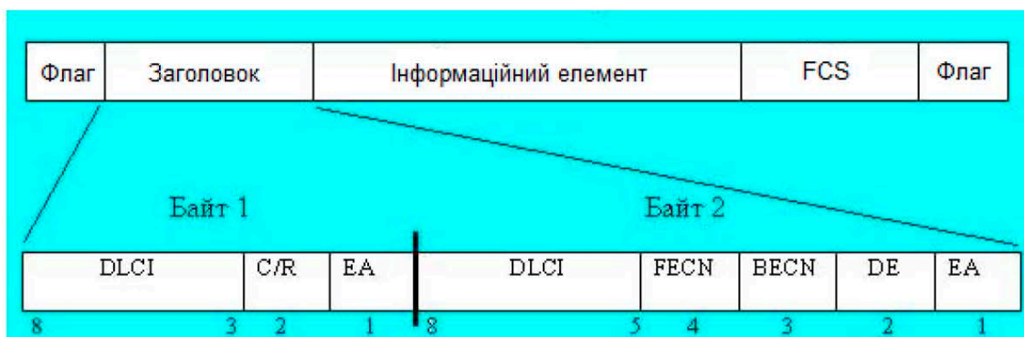
Рисунок 1.3. Вміст кадру Frame Relay
