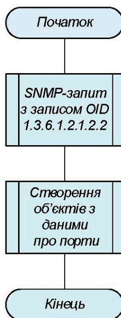
Рисунок 1.9. Блок-схема алгоритму читання таблиці портів маршрутизатору Cisco
