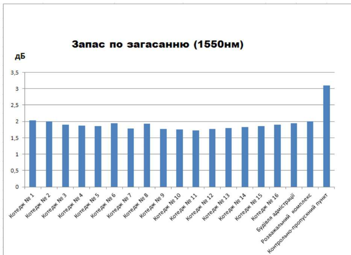
Рисунок 1.18. Графік зміни запасу по загасанню на довжині хвилі 1550нм для об'єктів котеджного містечка в залежності від відстані OLT
