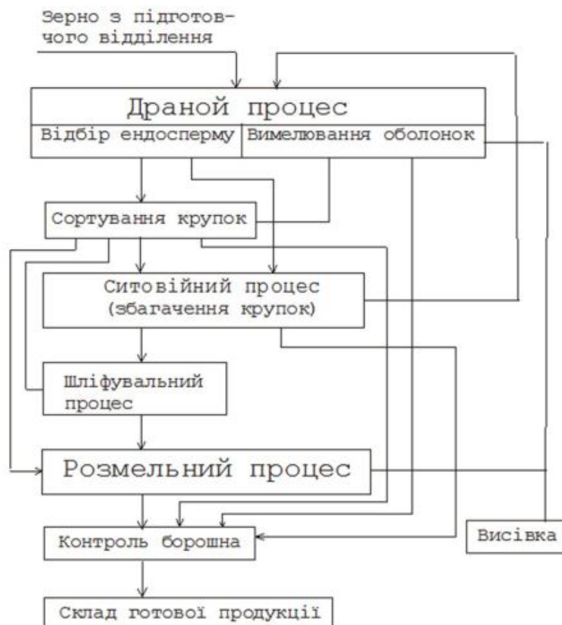
Рис. 5.3. Структурна схема розмелювального відділення млина
