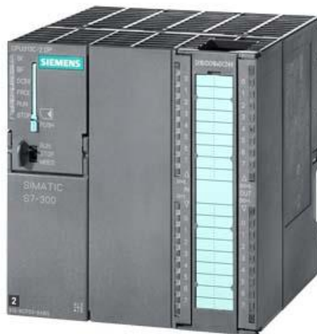
Рис. 4.4 – Центральний процесор CPU 313C-2DP (6ES7 313-6CG04-0AB0)
