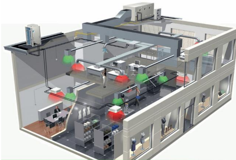
Рис.1.1 Система вентиляції магазинів.
