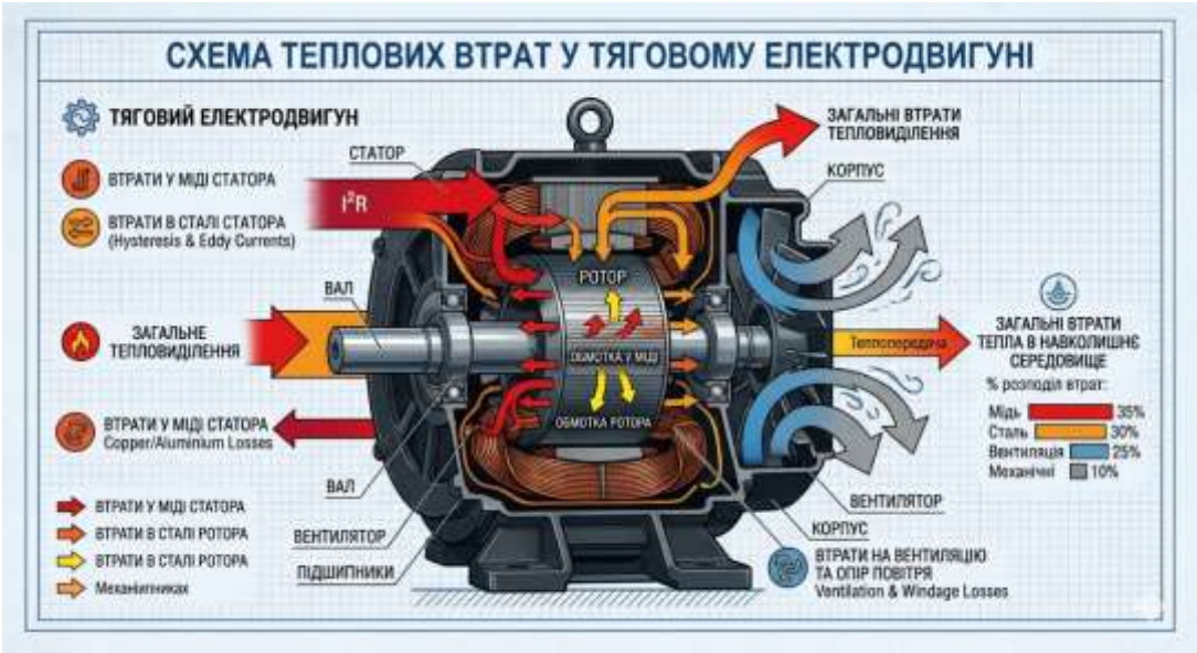
Рис.1.2 причини нагрівання обмоток електродвигунів
