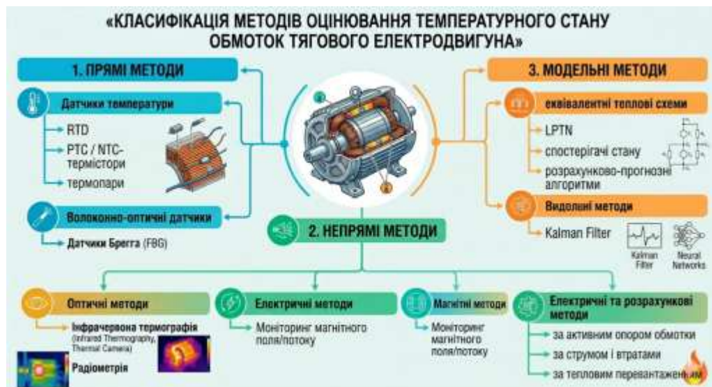
Рис. 2.2 Класифікація методів оцінювання температурного стану обмоток
