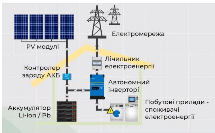
Рис. 1.4 Принцип роботи автономної сонячної електростанції
