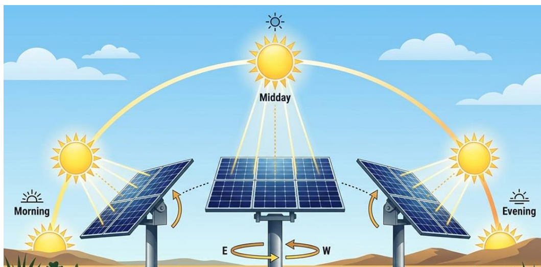
Рис. 1.5 Принцип роботи сонячного трекера
