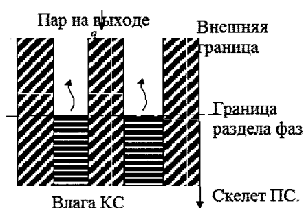
Рис. 1. Условная схема модели внутреннего испарения. Диагональная штриховка – элементы скелета; горизонтальная – влага в капилляре; криволинейные стрелки – выход пара, его диффузия в парогазовую смесь, находящуюся над границей раздела фаз в внутреннем капилляре
