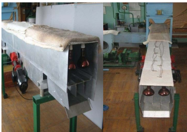
Рисунок 2. Фото експериментальної вібролоткової інфрачервоної сушарки (крильчатка, вивідні патрубки, регульовальний шибєр на фото не показані)
