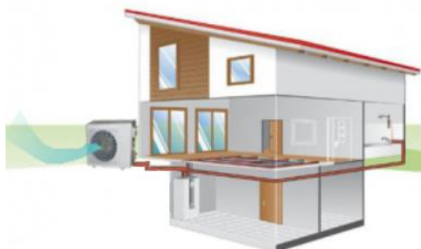
Рис.1.6 Схема тепловий насос повітряний - «повітря-вода»
