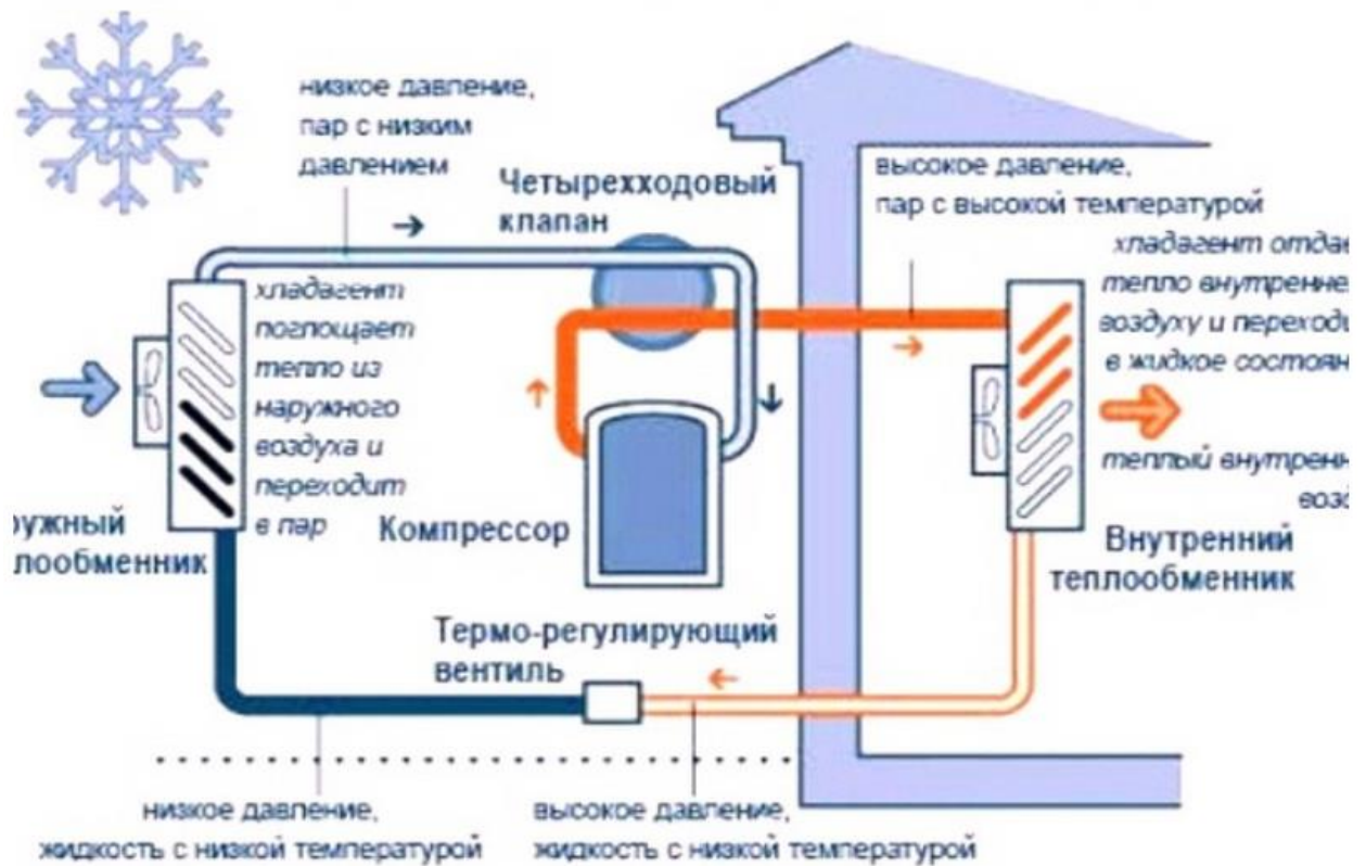
Рис.1.10 Пристрій і принцип роботи теплового насоса повітря-повітря
