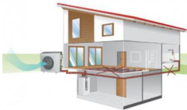
Рис.1.9 Тепловий насос повітряний - «повітря-повітря»
