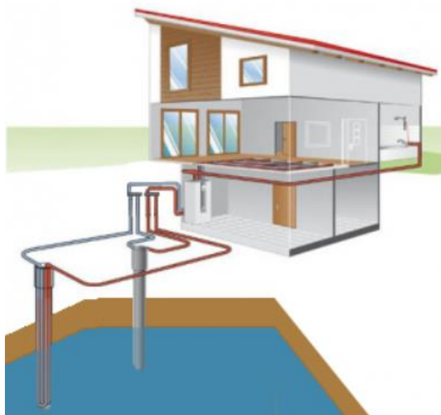
Рис.1.5 Схема тепловий насос водяний «вода-вода»
