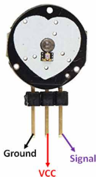
Рисунок 1.20. Конструкція і виводи давача пульса Pulse Sensor
