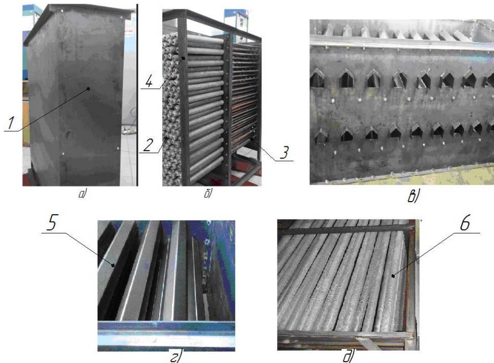
Рис. 46. Основні елементи зерносушарки на базі ТС: а) шаровий підігрівач із захисними кожухами, б) шаровий підігрівач, захисні кожухи знято; в) секція сушильної шахти вид збоку; г) секція сушильної шахти вид зверху; д) термосифонний калорифер; 1 – захисний кожух, 2 – випарна ділянка термосифонів, 3 – конденсаційна ділянка термосифонів, 4 – рама, 5 – канали для відведення вологого повітря, 6 – ребрені термосифони.
