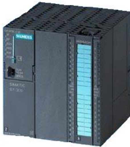
Рис. 5.2 – центральний процесор Siemens CPU 313C-2DP
