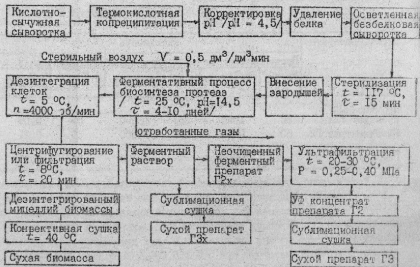
Рис.2. Технологическая схема получения ферментных препаратов из Penicillium roqueforti
