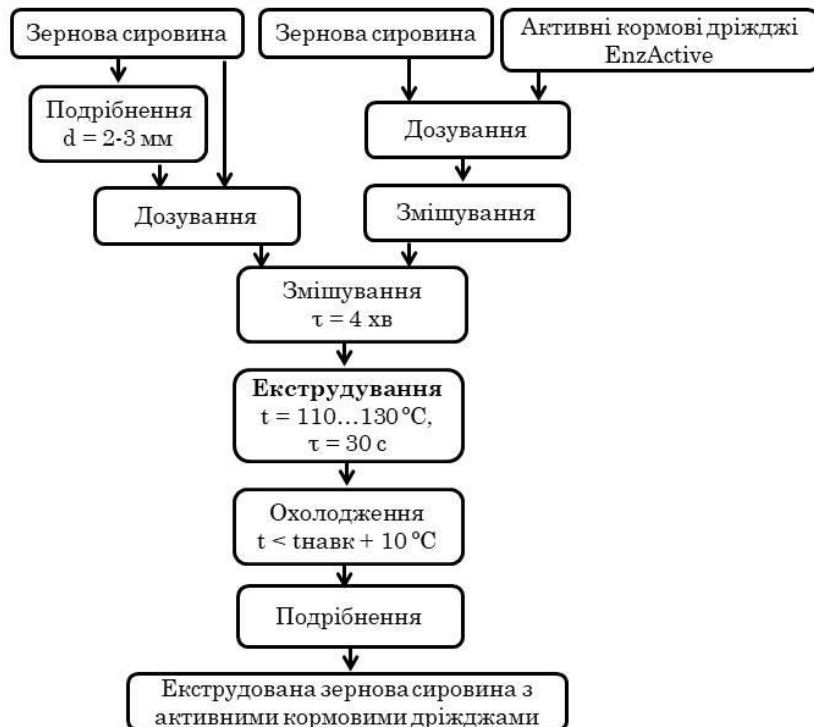
ФУНКЦІОНАЛЬНА СХЕМА ЕКСТРУДУВАННЯ ЗЕРНОВОЇ СИРОВИНИ З АКТИВНИМИ КОРМОВИМИ ДРІЖДЖАМИ
