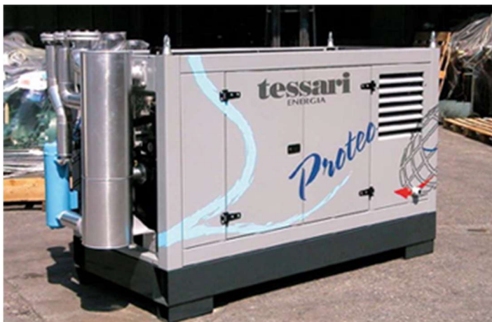
Рисунок 3.7 Когенераційних установка TESSARI
