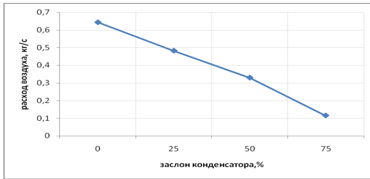
Рис. 4 Зміна витрат повітря в залежності від його зовнішнього забруднення (імітування заслоном частини прохідного переріза конденсатора).
