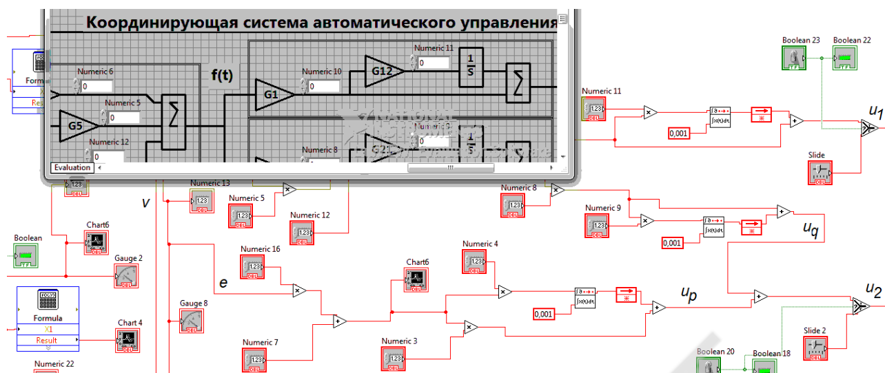
Рисунок 2. Представления дворовневого закону управління засобами середовища LabView, u_1 , u_2 – управляючі дії; u_P – управляюча дія другого рівня; u_q – управляюча дія першого рівня; v – відхилення від співвідношення значень регульованих змін; e – відхилення регульованої зміни від заданого значення
