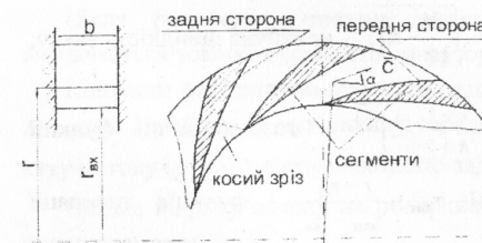
Рисунок 1 – Схема каналного дифузorzа
