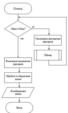
Алгоритм роботи підсистеми підтримки відносної вологості повітря в приміщенні
