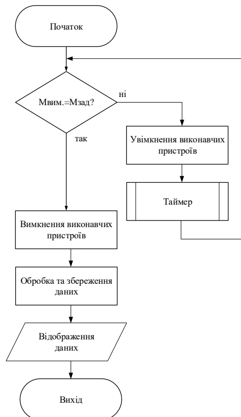
Рисунок 1.19 - Алгоритм роботи підсистеми підтримки відносної вологості повітря в приміщенні
