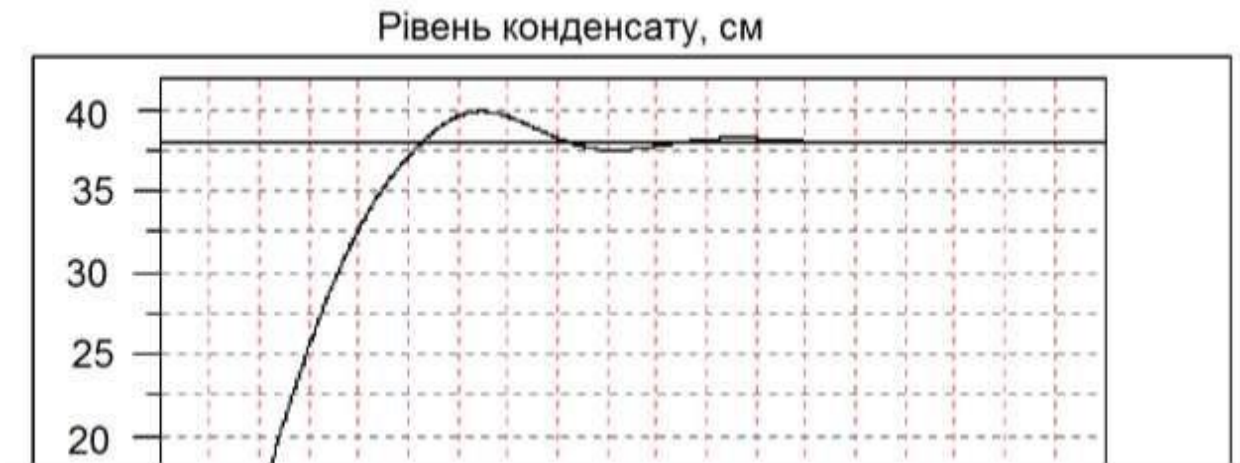
Рис. 6.15 (закінчення) – Перехідні характеристики, отримані при тестуванні і відлагодженні алгоритмів регулювання на моделі ОУ
