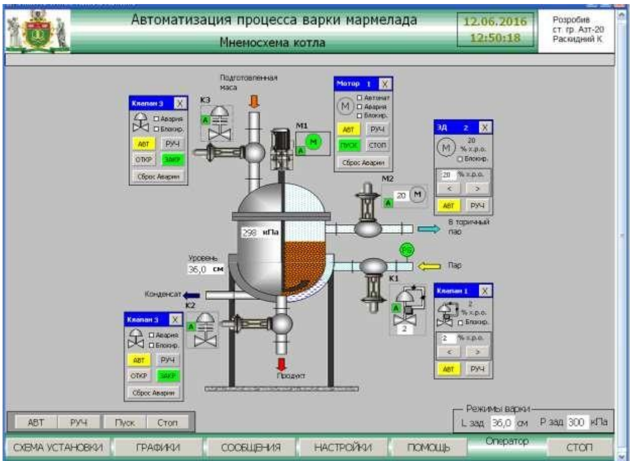
Рис. 7.10 – Загальний вигляд екрану «Мнемосхема котла» при відкритих екранних формах управління двигунами і клапанами
