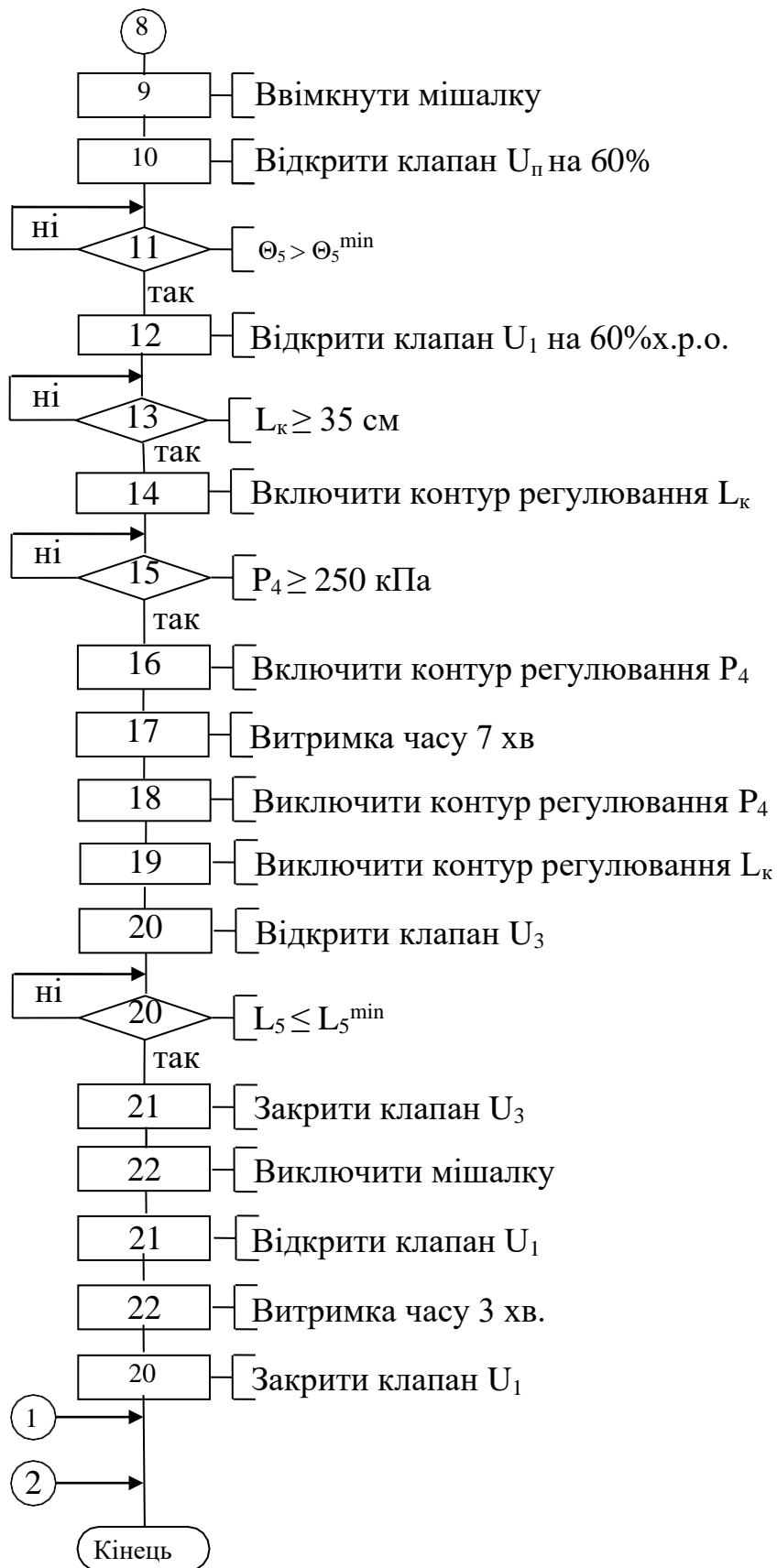
Рис. 4.3 (закінчення) – Блок-схема алгоритму логічного автоматичного керування процесом варки мармеладу
