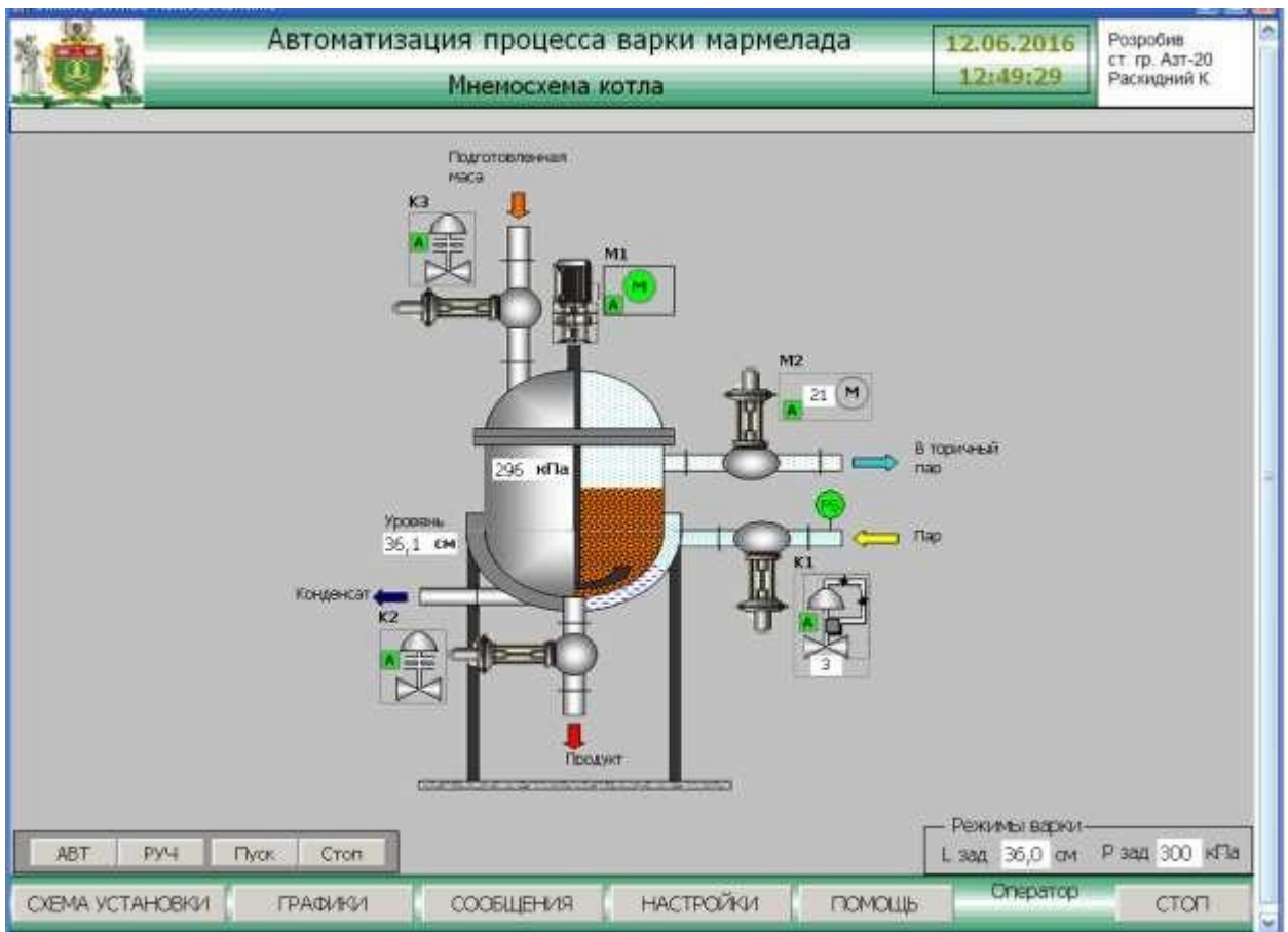
Рис. 7.9 – Загальний вигляд екрану «Мнемосхема котла» при нормальній роботі
