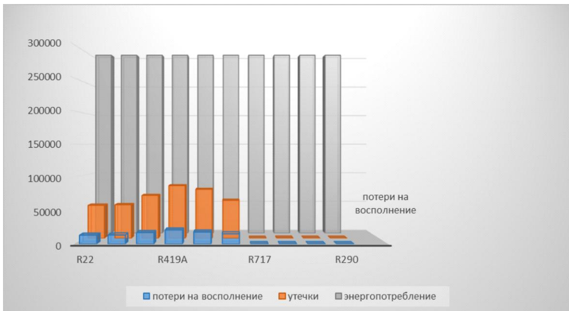
Рис. 1 Сравнительные показатели по суммарному влиянию на парниковый эффект атмосферы холодильных машин, работающих на различных хладагентах
