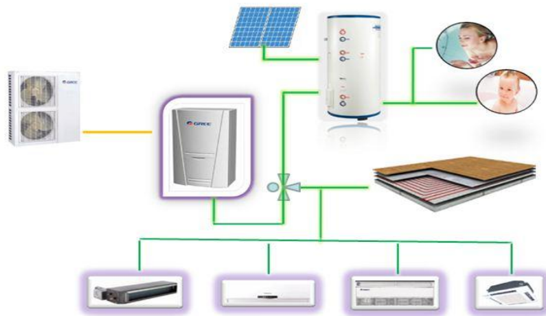
Рис. 1 Функціональна схема теплового насосу GREEVersati.
