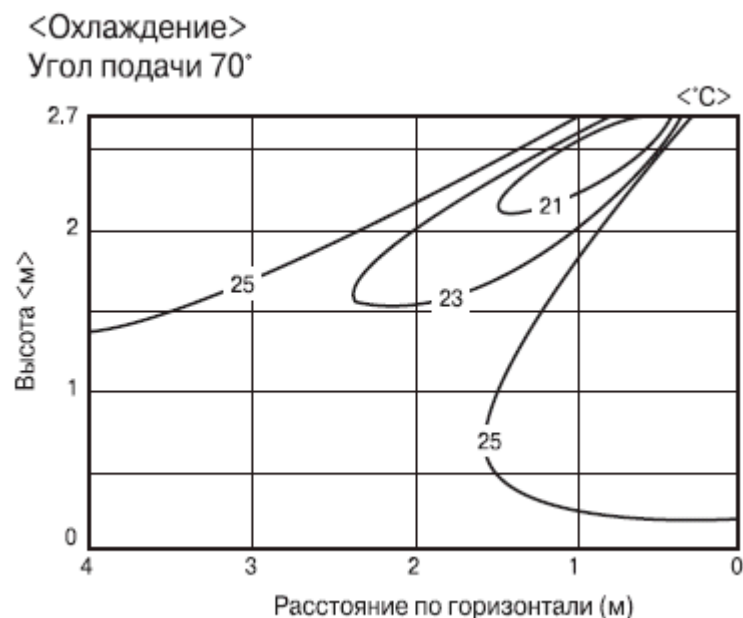
Рис. 6. Епюра температур повітря в припливній струмені касетного кондиціонера в режимі охолодження.
