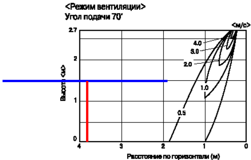
Рис. 9. Епюра швидкостей повітря в припливній струмені касетного кондиціонера.
