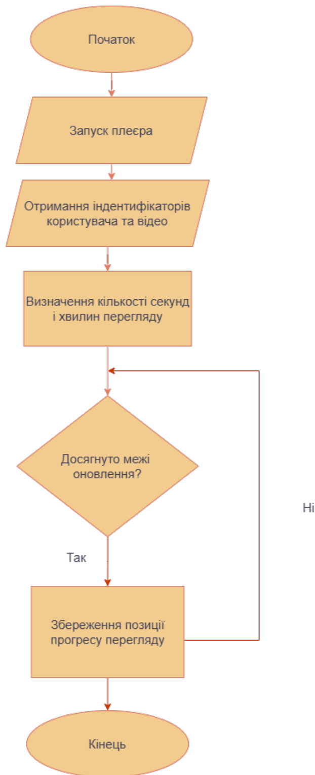
Рисунок 1.10 Блок-схема алгоритму моніторингу прогресу перегляду відео
