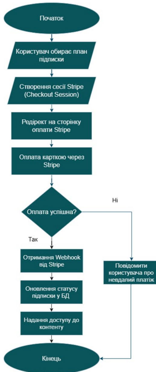
Рисунок 1.14 Блок-схема процесу оформлення та обробки підписки через Stripe
