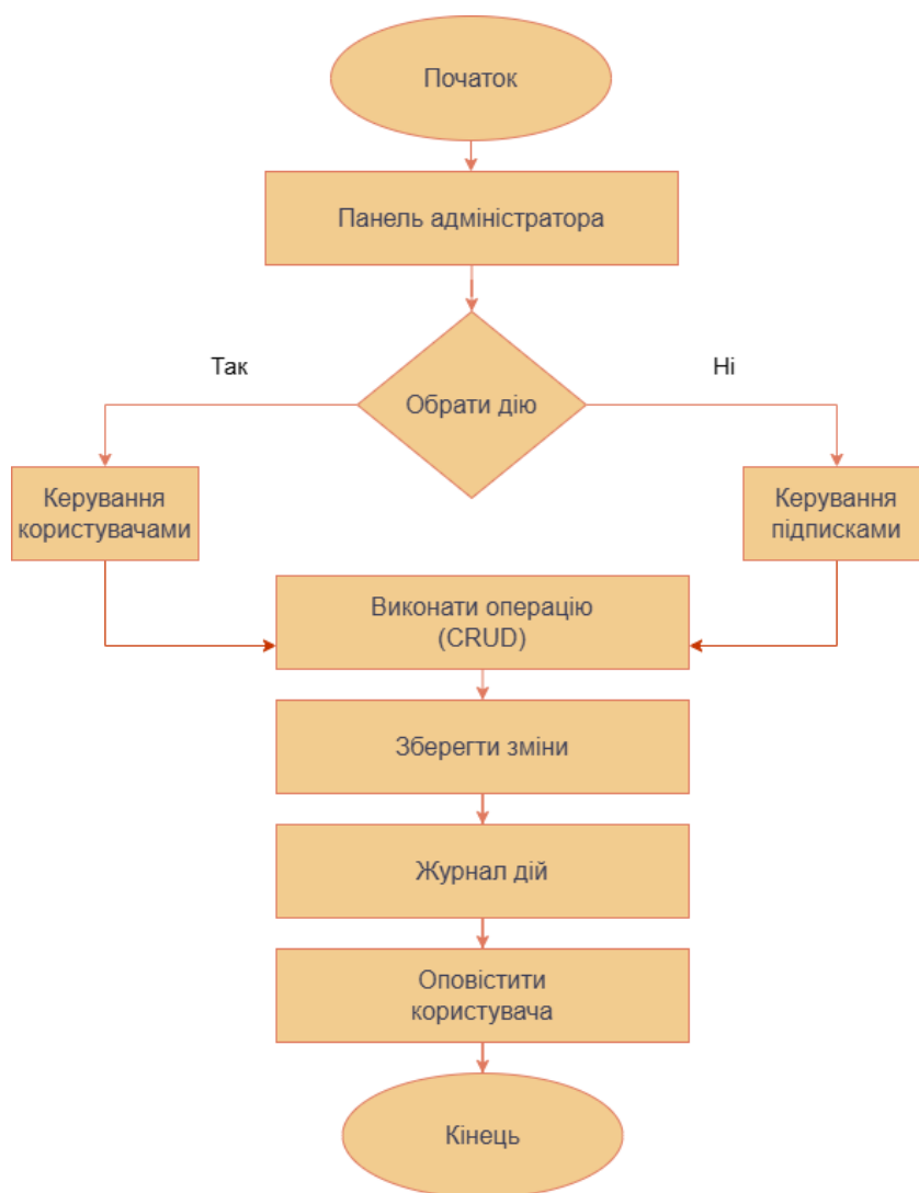
Рисунок 1.11. Алгоритм роботи панелі керування користувачами та підписками
